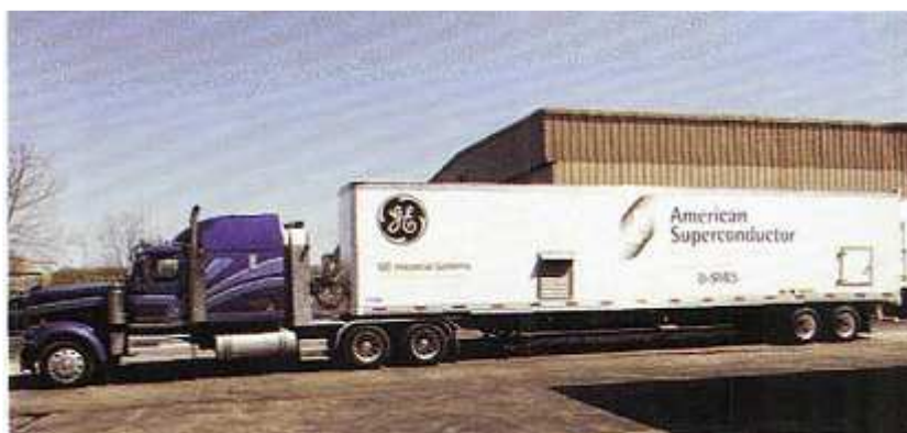
Rys.8. Kontenerowy zasobnik D-SMES magazynujący energię 3 MJ [1]
